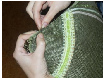
Рис. 16. Закрытие проема потайным швом
